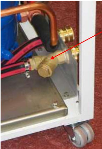
Dévisser la tête à l'endroit de l'appareil. Ouvrir le boîtier à filtre à l'aide d'une clé à fourche 19 ou 27, nettoyer le filtre et replacer le tout.
