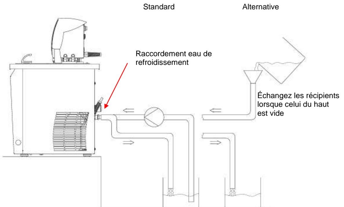
Remplissez l'appareil en ajoutant un produit détartrant via le tuyau d'eau (pompe ou tuyau). Réglez la valeur de consigne sur 10 °C et après la mise en marche du groupe froid, remplissez le circuit d'eau. Pompez le détartrant, resp. versez le produit détartrant en permanence. Laissez agir (voir tableau ci-dessous).
