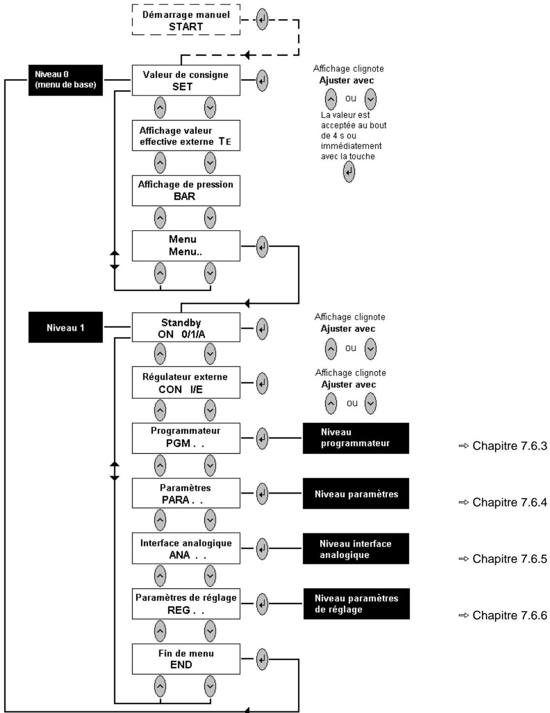
Pour obtenir un réglage de base pour presque toutes les fonctions et permettre ainsi un fonctionnement se basant sur une régulation interne, utilisez la fonction de défaut dans le menu Paramètres (⇒ Chapitre 7.6.4.7).
